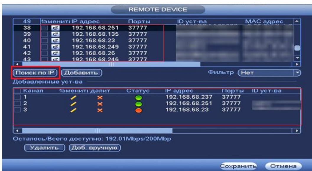
Рисунок 6.8 Настройка добавления камер по поиску в сети.
