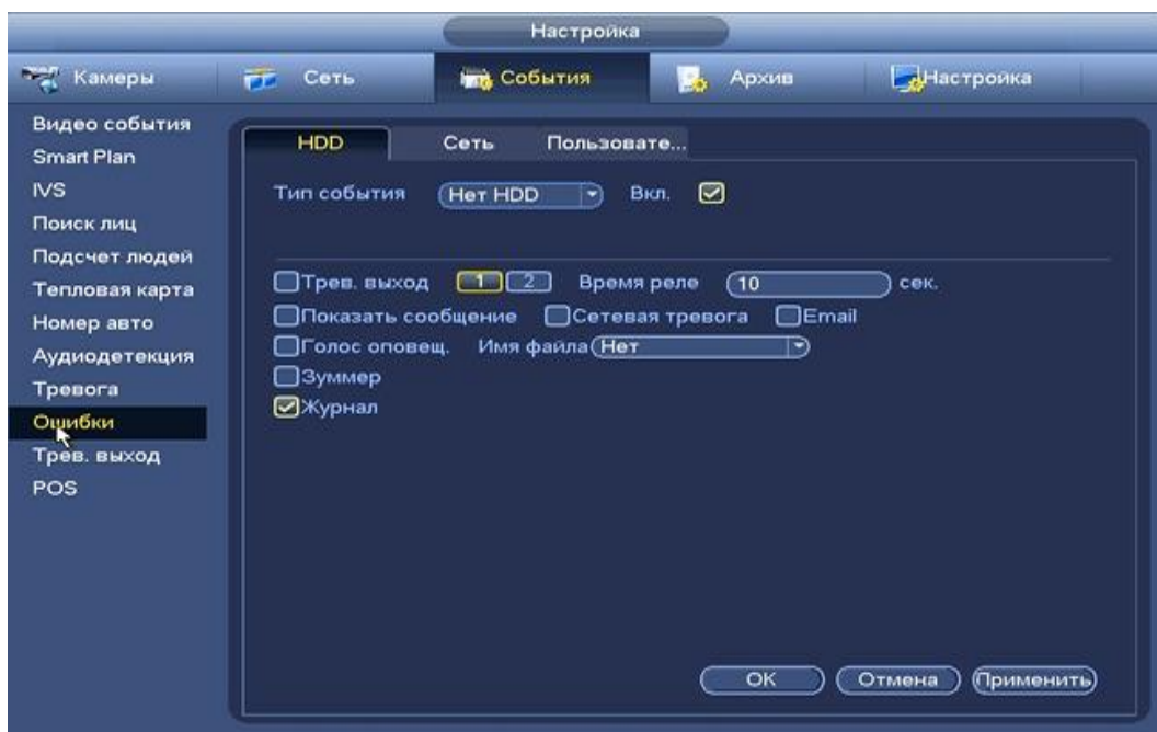
Рисунок 8.138 Интерфейс настройки HDD.
