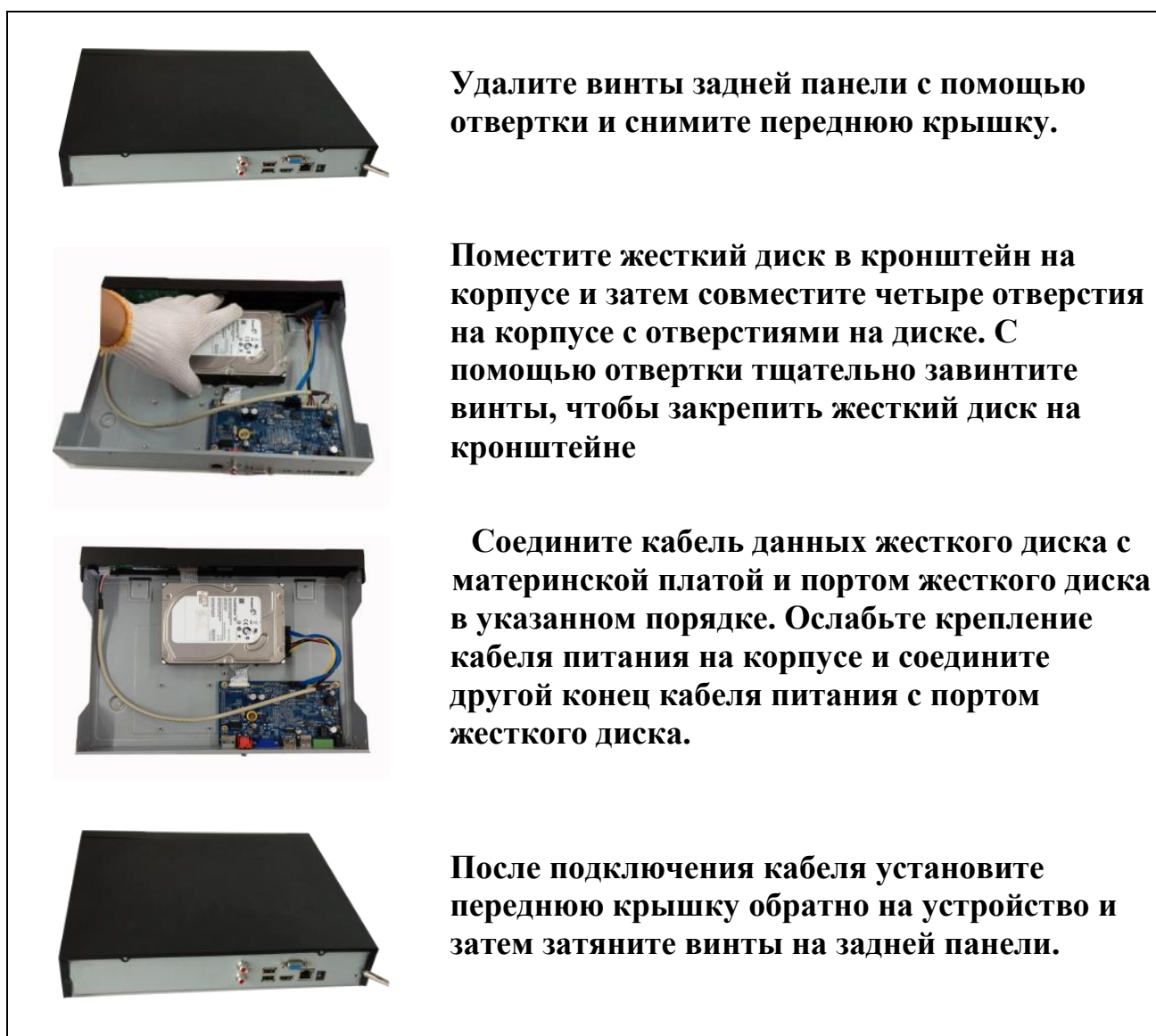
Рисунок 5.1 Установка жесткого диска
