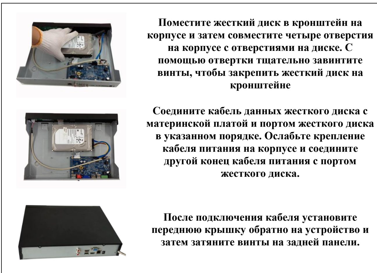
Рисунок 5.1 Установка жесткого диска
