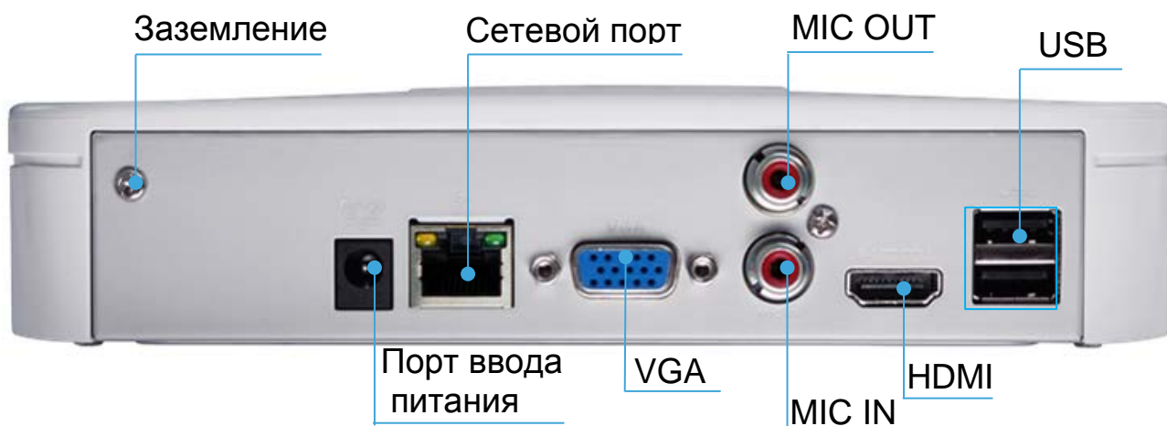
Рисунок 3.2 – Внешний вид задней панели Расшифровка обозначений портов видеорегистратора (см. Таблица 3.2).
