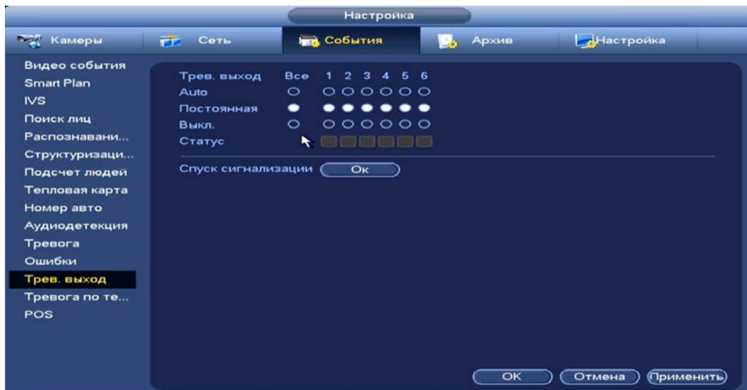
Рисунок 14.12 – Настройка записи по тревожному выходу
