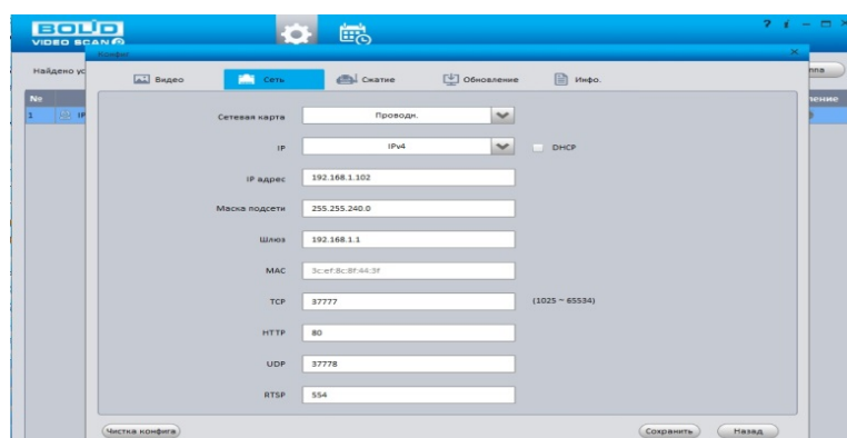
Рисунок 27.2 – Изменение IP-адреса с помощью утилиты «BOLID VideoScan»
