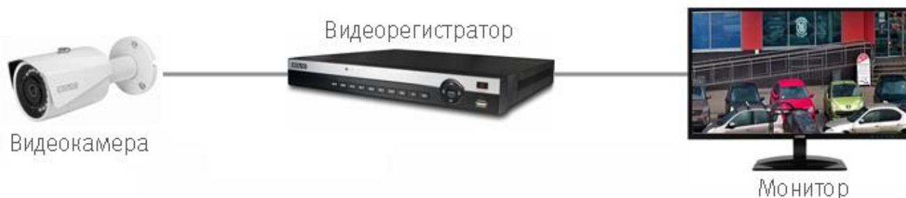
Рисунок 6.2 – Схема подключения видеокамеры
