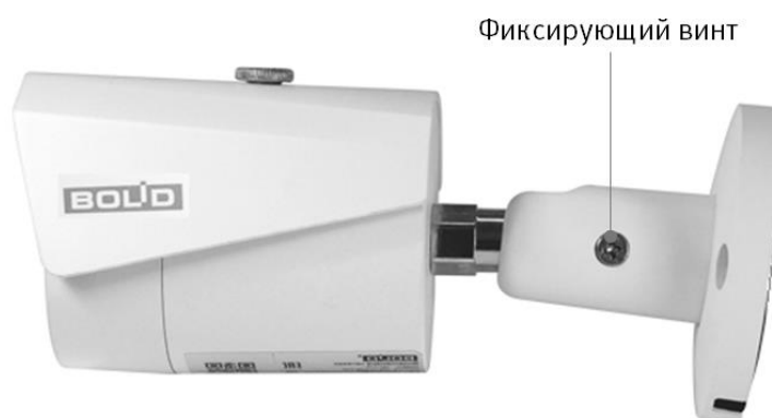
Рисунок 6.4 – Настройка направления объектива
