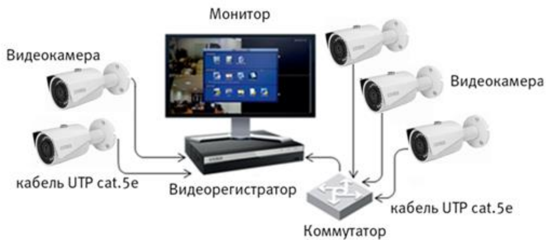
Рисунок 6.4 – Схема подключения видеокамеры к видеорегистратору
