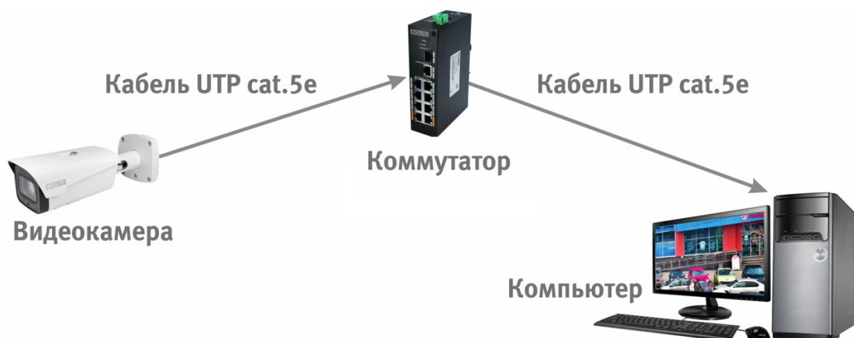
Рисунок 6.4 – Схема подключения видеокамеры к компьютеру через коммутатор
