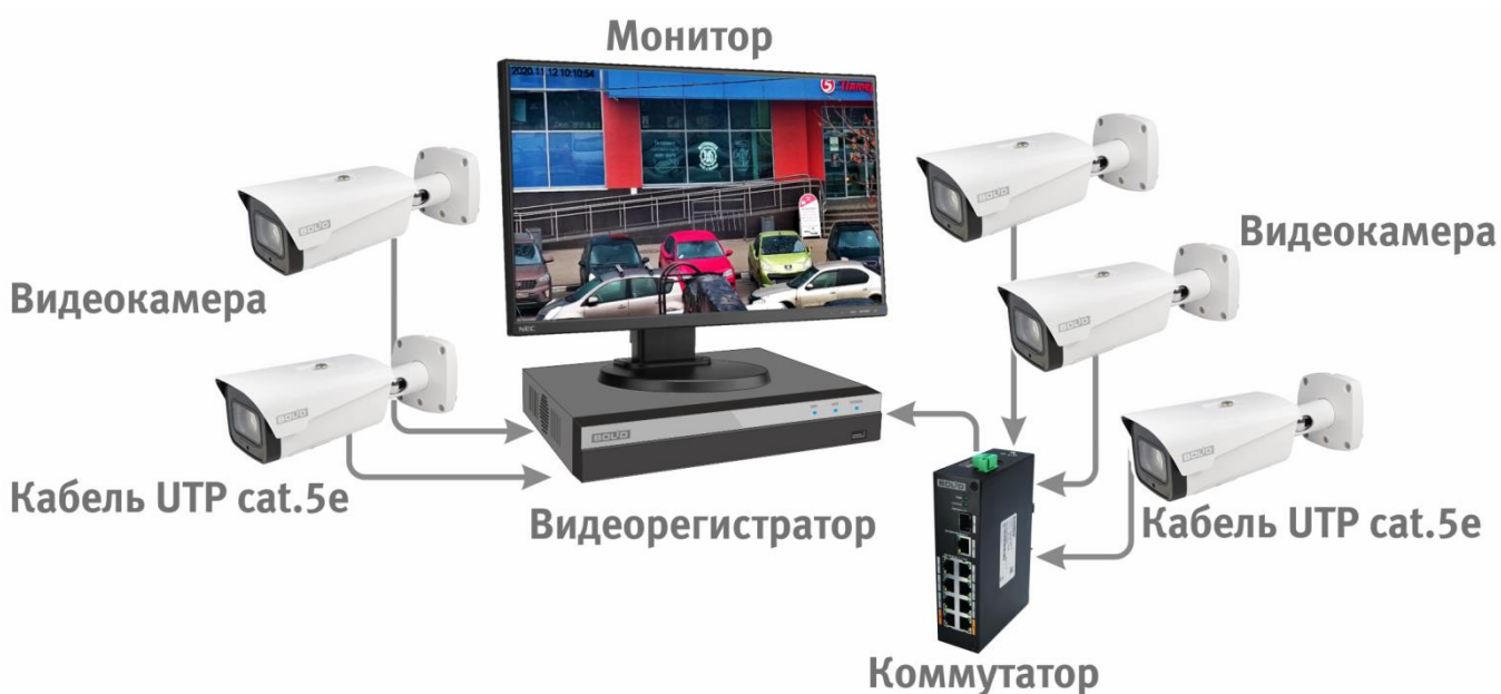
Рисунок 6.5 – Схема подключения видеокамеры к видеорегистратору
