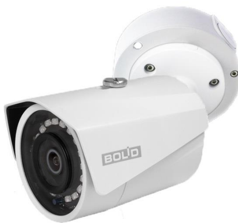
Рисунок 5.4 – Потолочное крепление видеокамеры на монтажной коробке BR-204
