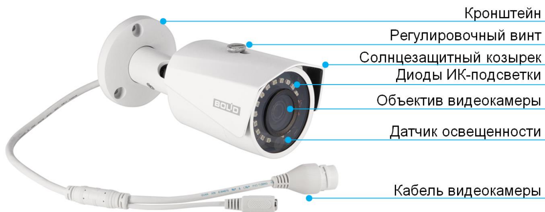
Рисунок 4.1 - Внешний вид и основные элементы видеокамеры
