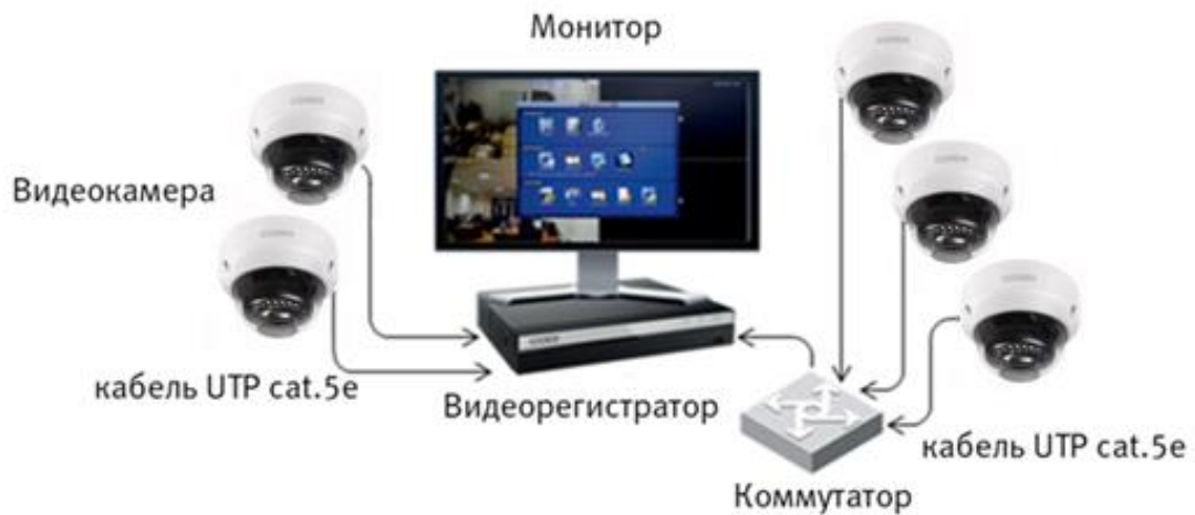
Рисунок 6.4 – Схема подключения видеокамеры к видеорегистратору
