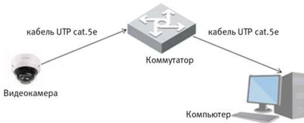
Рисунок 6.3 - Схема подключения видеокамеры к компьютеру через коммутатор
