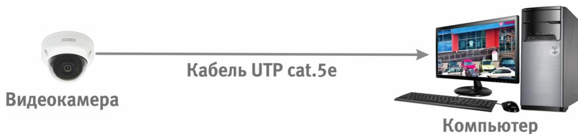
Рисунок 6.2 – Схема подключения видеокамеры к компьютеру
