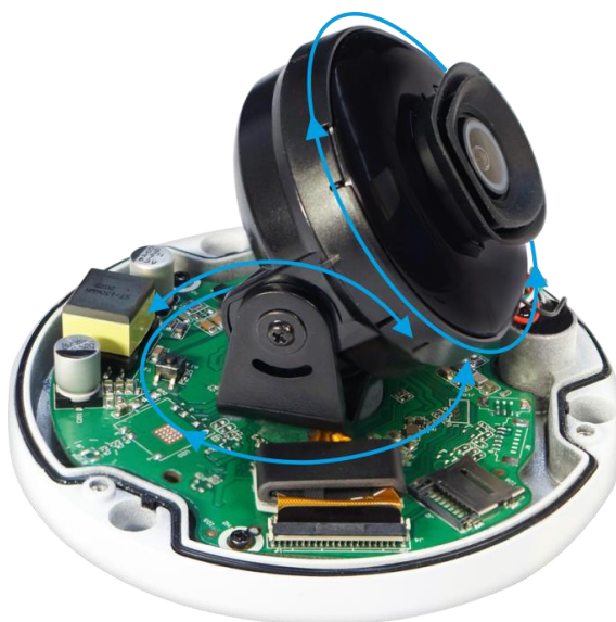
Рисунок 5.7 – Настройка направления объектива
