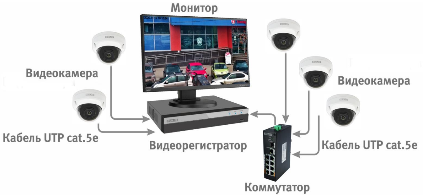
Рисунок 6.4 – Схема подключения видеокамеры к видеорегистратору
