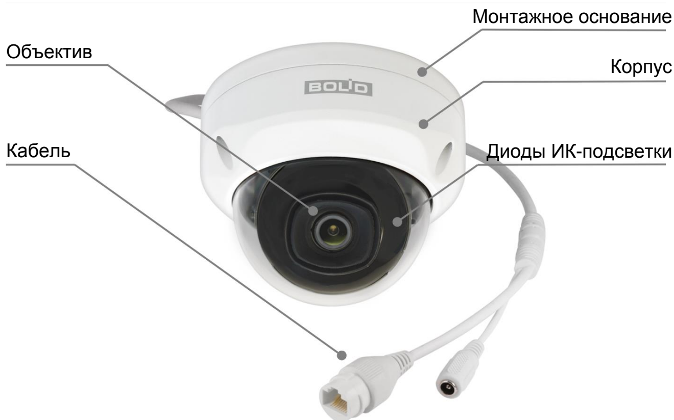
Рисунок 4.1 – Внешний вид и основные элементы видеокамеры
