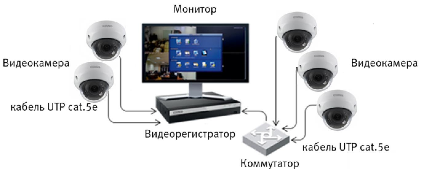
Рисунок 6.4 – Схема подключения видеокамеры к видеорегистратору
