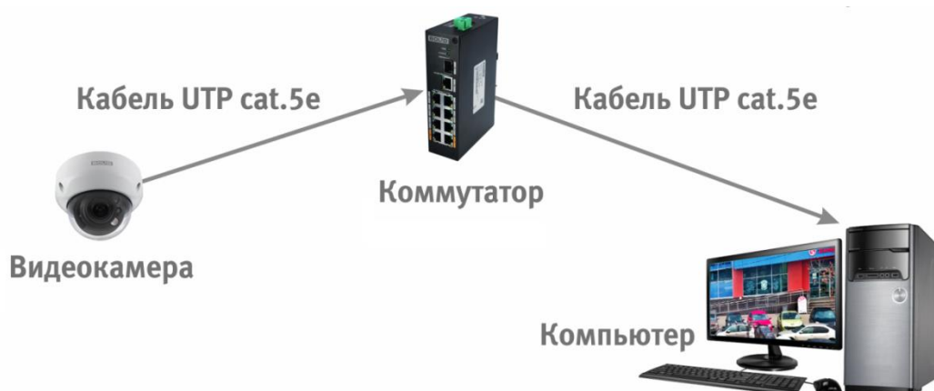
Рисунок 6.3 – Схема подключения видеокамеры к компьютеру через коммутатор
