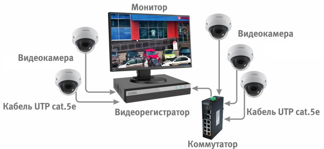
Рисунок 6.4 – Схема подключения видеокamеры к видеорегистратору
