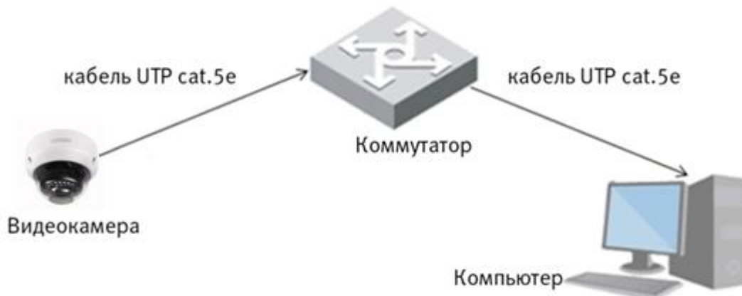
Рисунок 6.3 - Схема подключения видеокамеры к компьютеру через коммутатор
