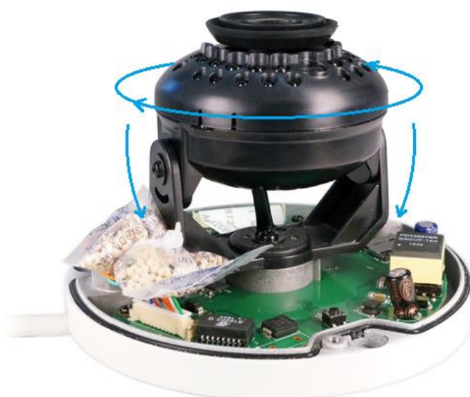
Рисунок 5.7 – Настройка направления объектива
