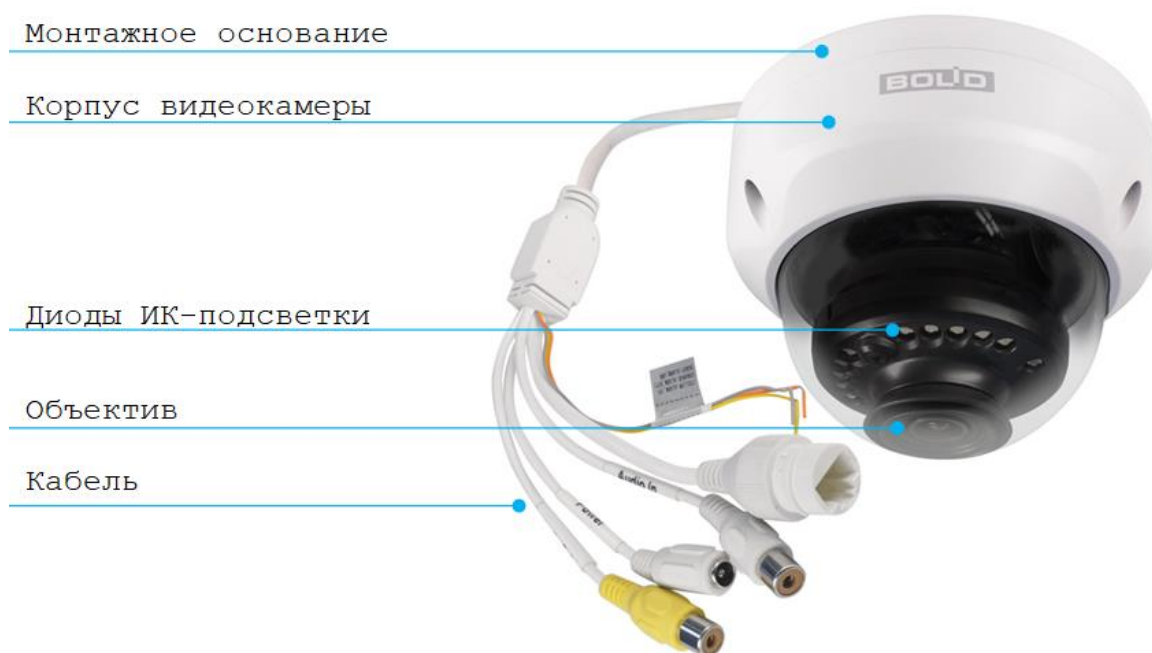
Рисунок 4.1 - Внешний вид и основные элементы видеокамеры
