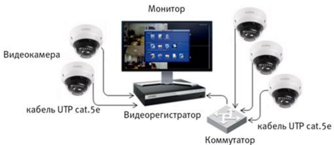
Рисунок 6.4 – Схема подключения видеокамеры к видеорегистратору
