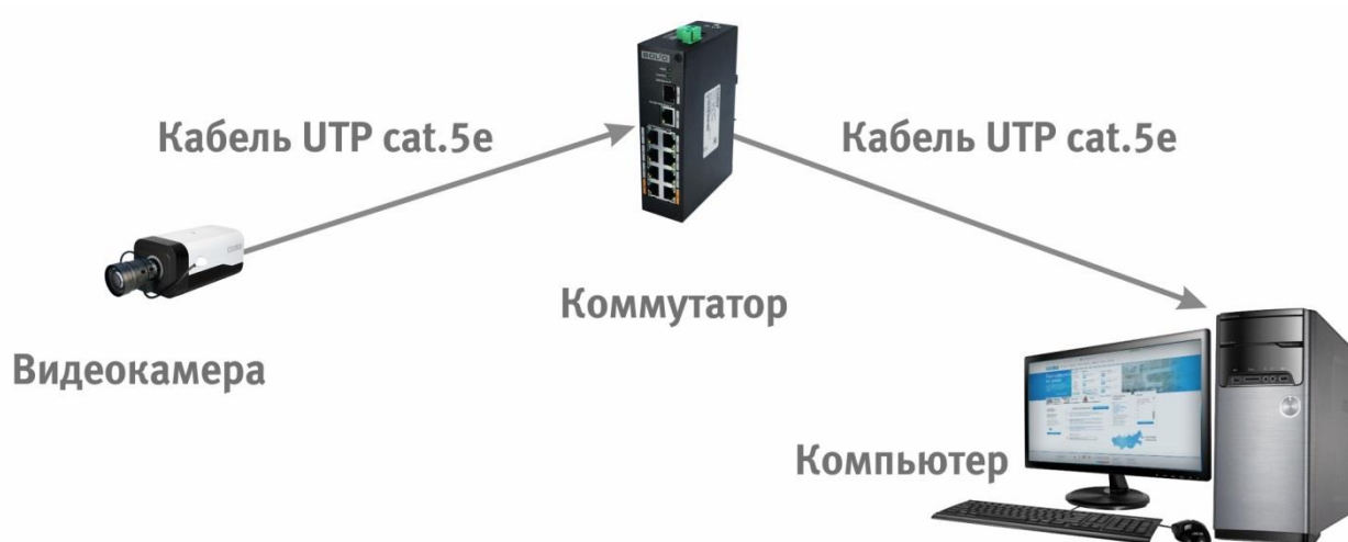
Рисунок 8.3 - Схема подключения видеокамеры к компьютеру через коммутатор
