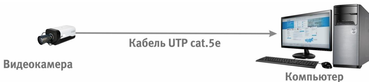
Рисунок 8.2 – Схема подключения видеокамеры к компьютеру
