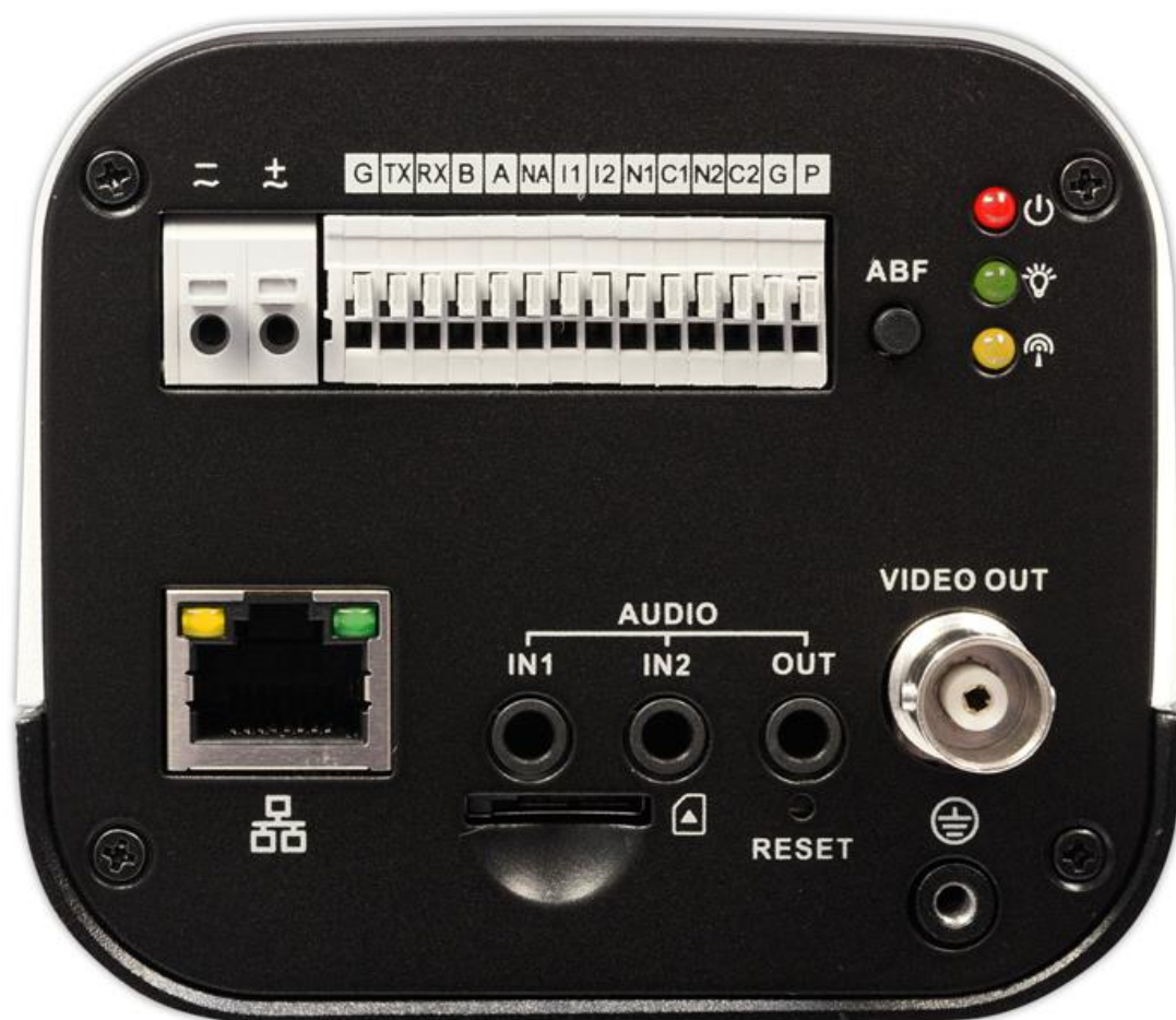
Рисунок 8.1 – Задняя панель видекамеры
