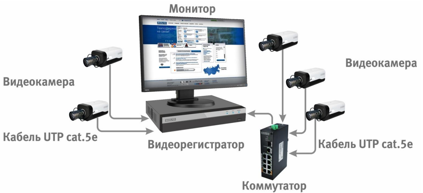
Рисунок 8.4 – Схема подключения видеокамеры к видеорегистратору
