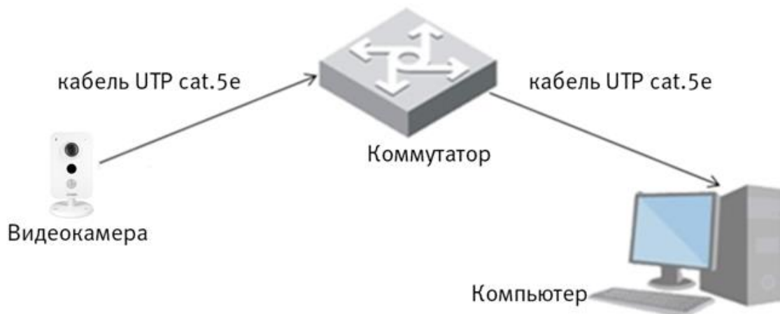
Рисунок 6.4 - Схема подключения видеокамеры к компьютеру через коммутатор
