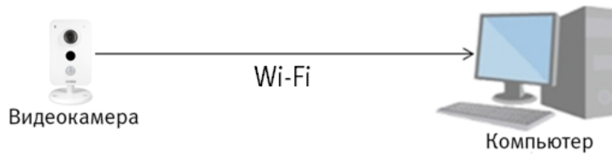
Рисунок 6.3 - Схема подключения видеокамеры к компьютеру по Wi-Fi
