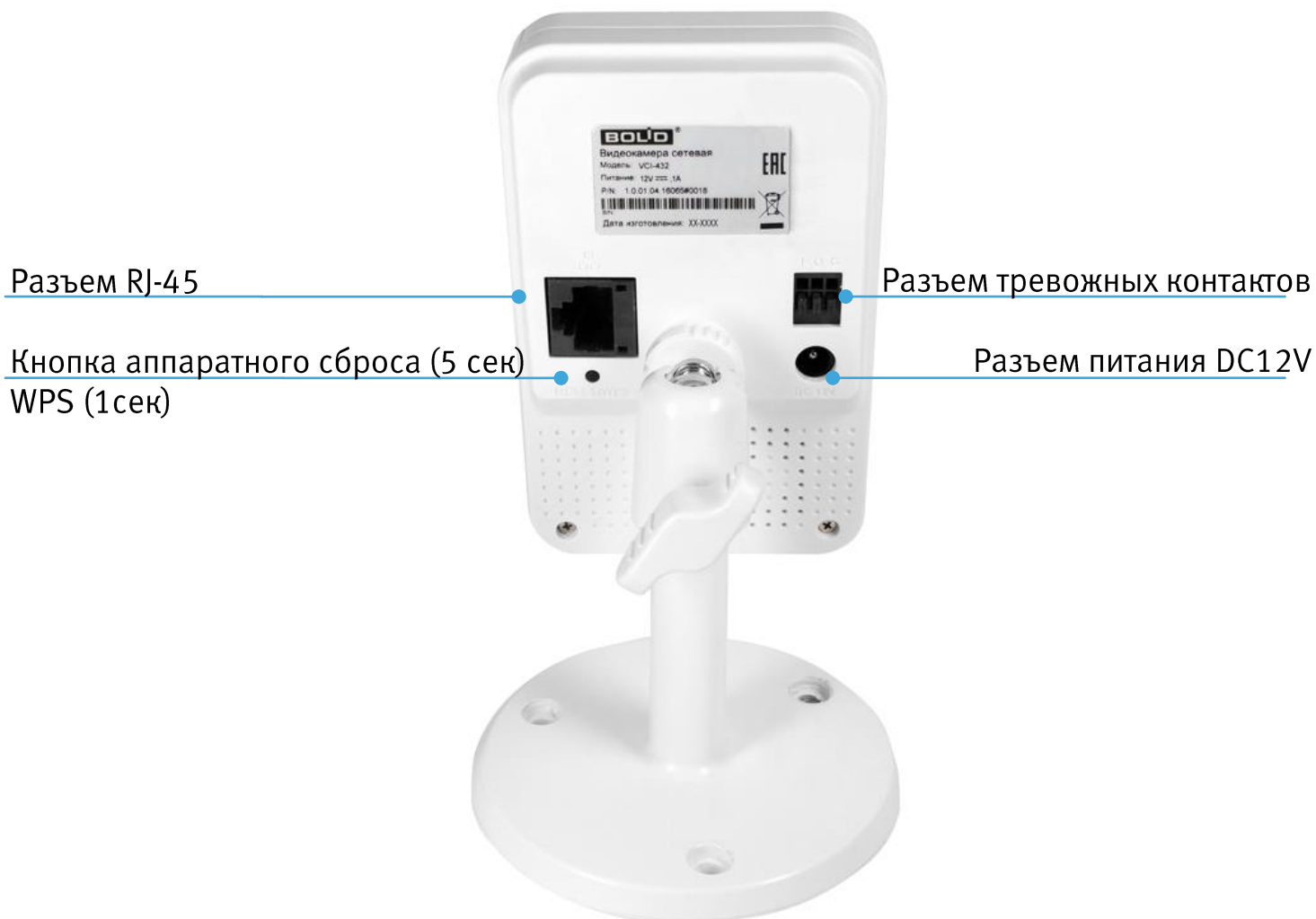
Рисунок 6.1 – Разъемы видеокамеры
