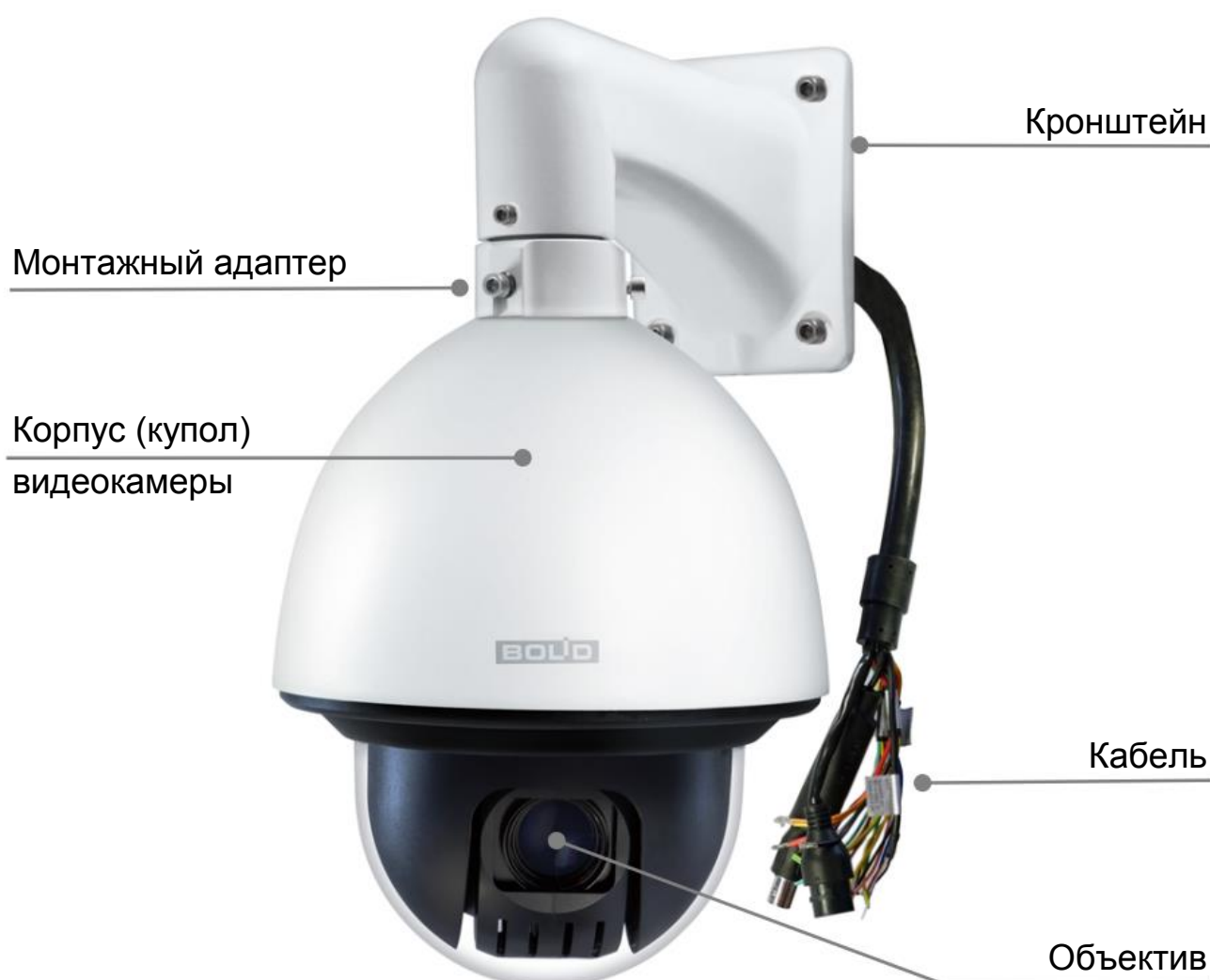
Рисунок 4.1 – Внешний вид и основные элементы видеокамеры
