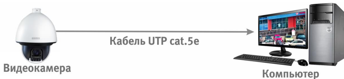
Рисунок 6.2 – Схема подключения видеокамеры к компьютеру
