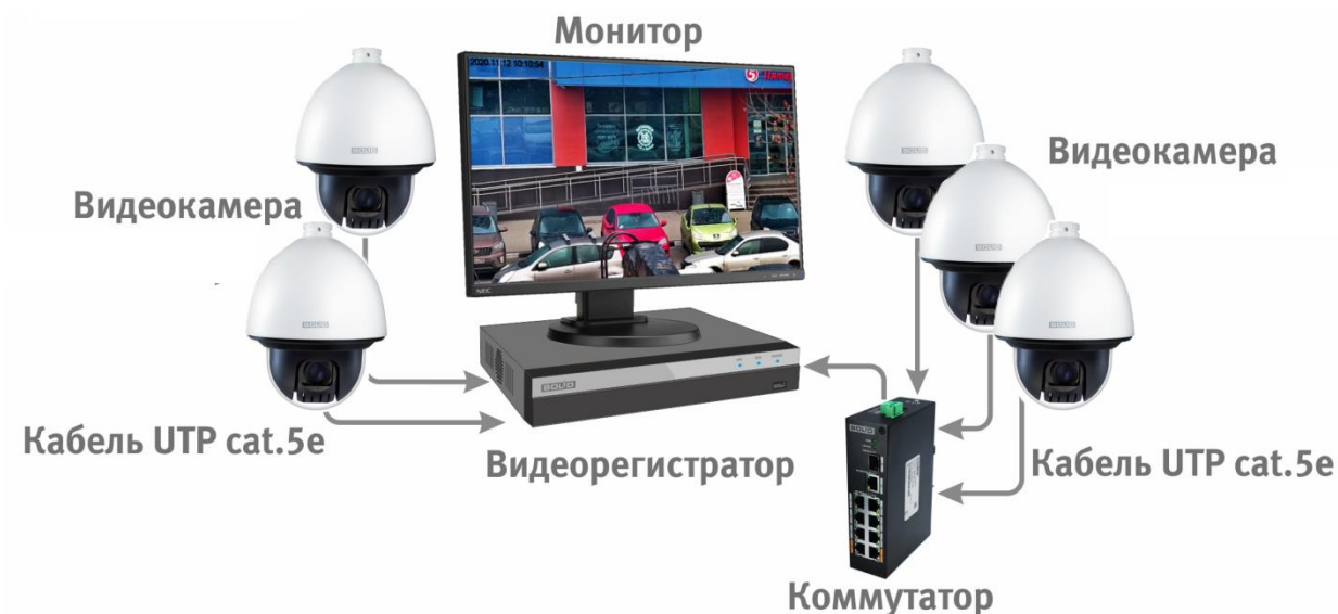
Рисунок 6.4 – Схема подключения видеокамеры к видеорегистратору
