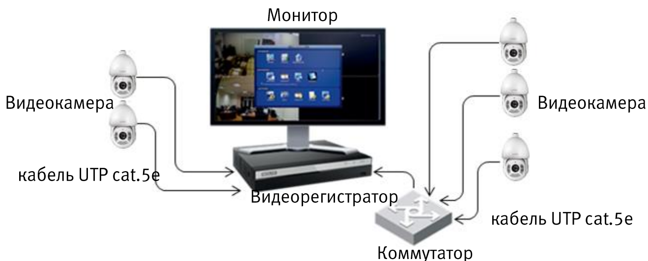
Рисунок 2.8 – Схема подключения видеокамеры к видеорегистратору
