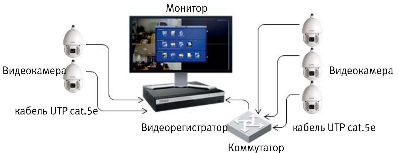
Рисунок 2.5 – Схема подключения видеокамеры к видеорегистратору
