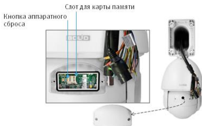
Рисунок 2.2 - Расположение слота для карты памяти и кнопки аппаратного сброса
