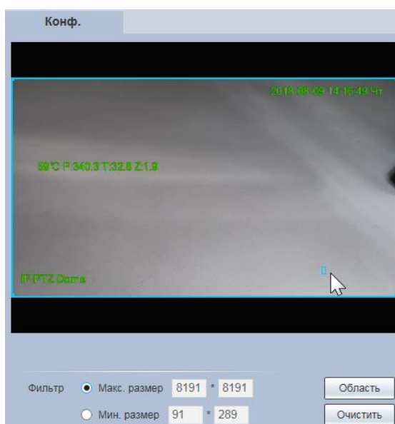
Рисунок 7.118 – Численное конфигурирование размеров контролируемой зоны
