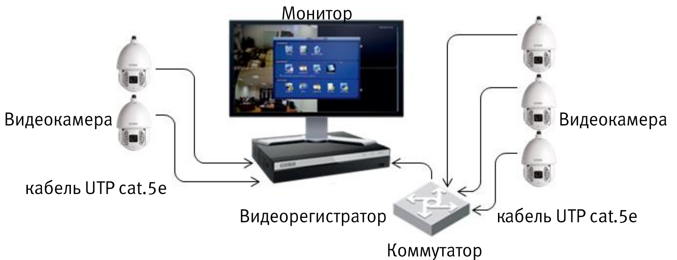
Рисунок 6.4 – Схема подключения видеокамеры к видеорегистратору
