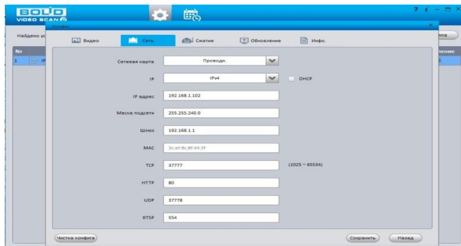
Рисунок 12.2 – Изменение IP-адреса видеокамеры с помощью утилиты «BOLID VideoScan»
