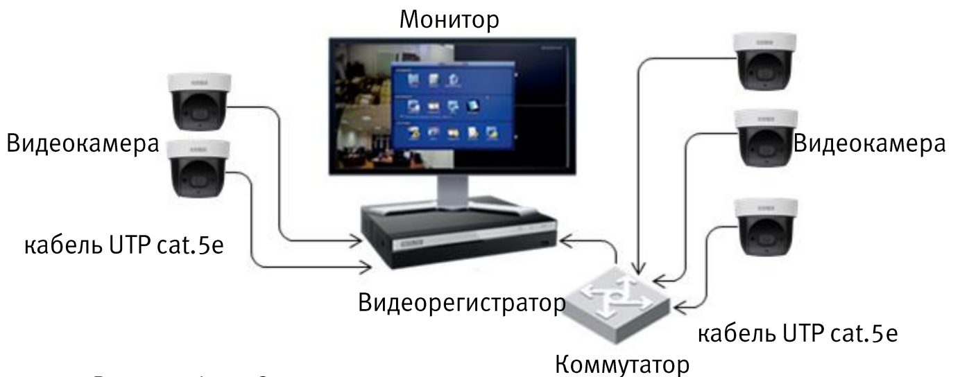
Рисунок 6.4 – Схема подключения видеокамеры к видеорегистратору
