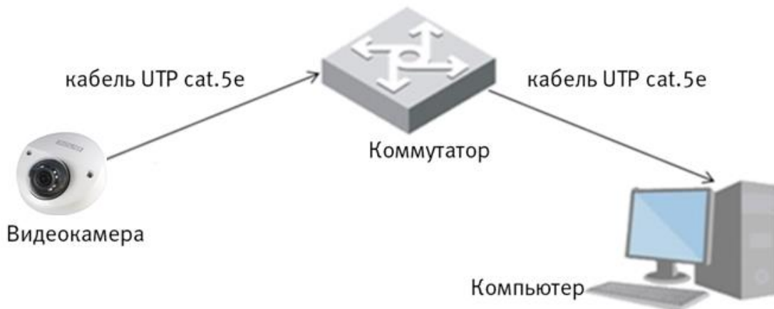
Рисунок 6.3 - Схема подключения видеокамеры к компьютеру через коммутатор
