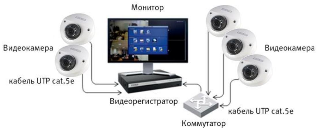
Рисунок 6.4 – Схема подключения видеокамеры к видеорегистратору
