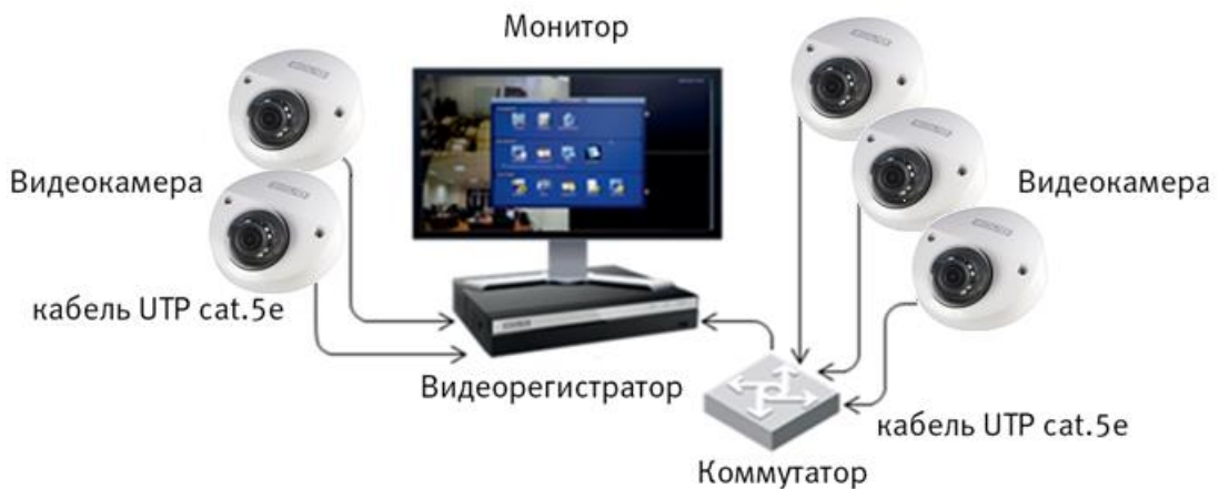
Рисунок 6.4 – Схема подключения видеокамеры к видеорегистратору
