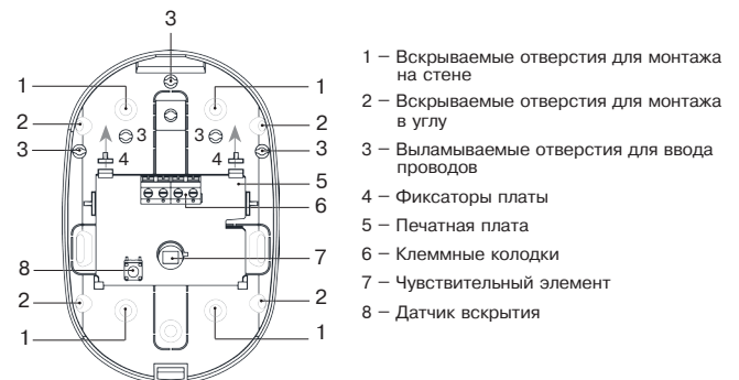
Рисунок 2 – Основание с установленной печатной платой
