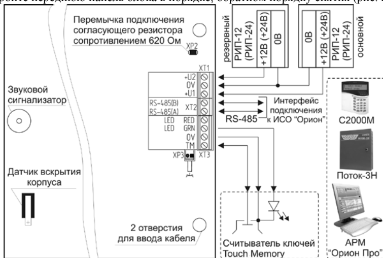
Рисунок 3. Схема внешних соединений блока «Поток-БКИ»
