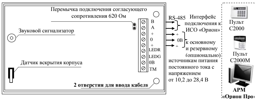
Рисунок 3. Схема внешних соединений блока
