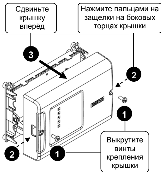
Рисунок 2. Снятие крышки блока
