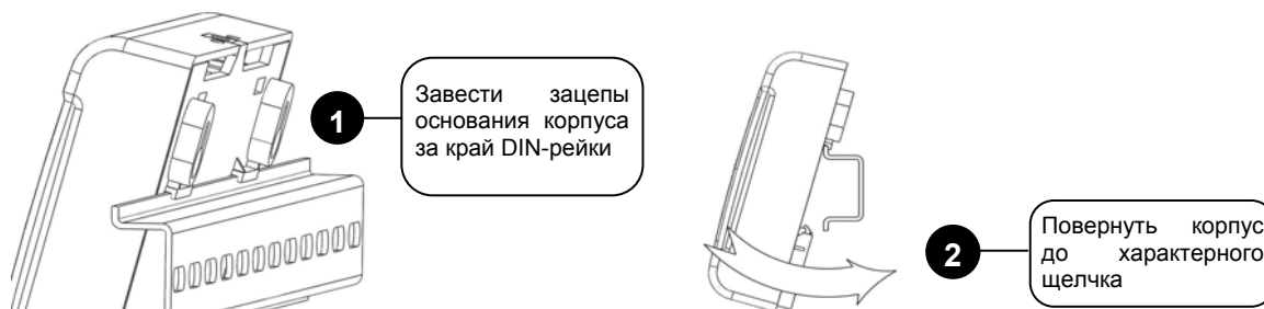
Рисунок 4. Монтаж прибора на DIN-рейку
