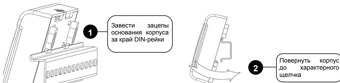
Рисунок 4. Монтаж прибора на DIN-рейку
